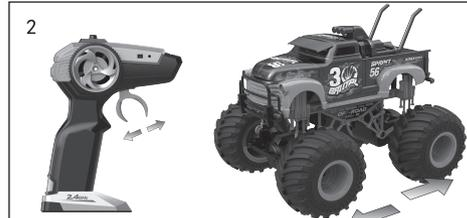
2. Drücken Sie den Hebel des Senders nach vorne oder nach hinten, damit das Auto vorwärts oder rückwärts fährt. (Langsam drücken, um ein ruckartiges Auslaufen des Fahrzeugs zu vermeiden).
