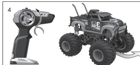
4. Wenn Sie das Lenkrad am Sender gegen den Uhrzeigersinn drehen, fährt das Auto nach links.
