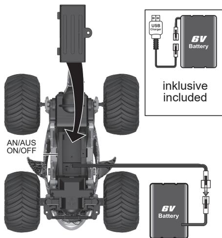
1. Nehmen Sie die Akkuabdeckung des RC-Fahrzeugs runter, legen Sie den 6V-Akku ein, befestigen Sie die Abdeckung, und schalten Sie den Schalter auf "ON".
