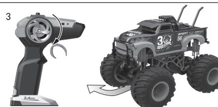
3. Wenn Sie das Lenkrad am Sender im Uhrzeigersinn drehen, fährt das Auto nach rechts.
