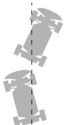
Dieses Produkt hat die Funktion des ESP-Fahrzeugstabilitätssystems, das die Lage und Richtung des Fahrzeugs effektiv korrigieren kann, wenn das Fahrzeug ins Schleudern gerät oder die Kontrolle verliert. Die Funktion und die Empfindlichkeit des Auto-Gyroskopsensors können über den ESP-Knopf des Senders eingestellt werden.
