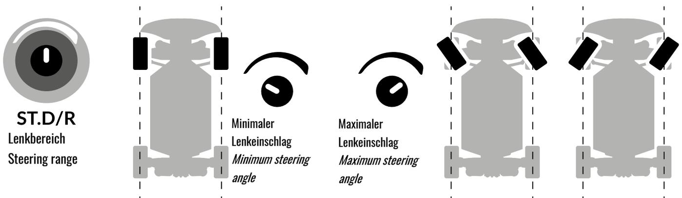
Über den Einstellknopf kann der maximale Lenkeinschlag definiert werden.
