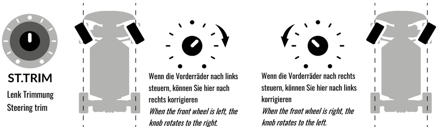
Wenn das Lenkrad in der Neutralstellung ist und das Fahrzeug trotzdem nach links oder rechts lenkt, können Sie die Lenkung über die Trimmung korrigieren.
