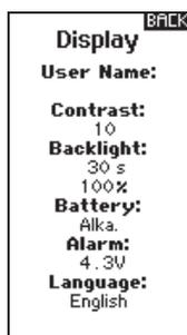
**ATTENZIONE:** non scegliere NiMH quando nel trasmettitore è installata una batteria LiPo/ Li-Ion. La batteria LiPo potrebbe scaricarsi eccessivamente, danneggiando sia la batteria che il trasmettitore.
