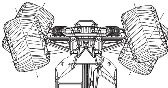
\*ステアリングホイールの操作量に応じて舵角が変わります。操作量が大きいほど、舵角も大きくなります。
