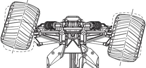
▶ ステアリングD/Rアジャスターを右側に一杯回した所から、1目盛分戻した所が最大舵角の目安となります。
